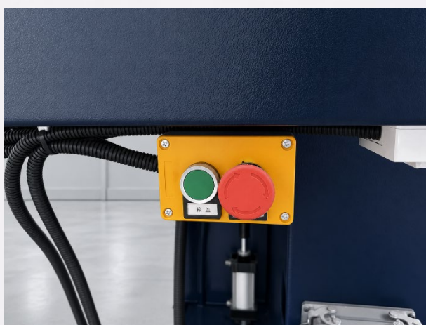
КНОПКА АВАРИЙНОЙ ОСТАНОВКИ
